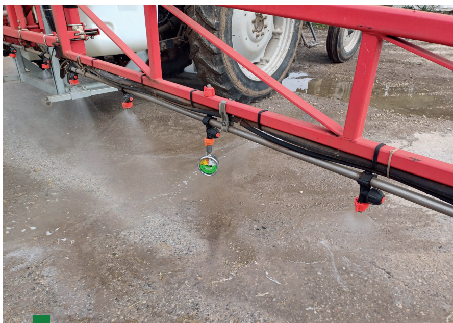
Taratura macchina irroratrice
